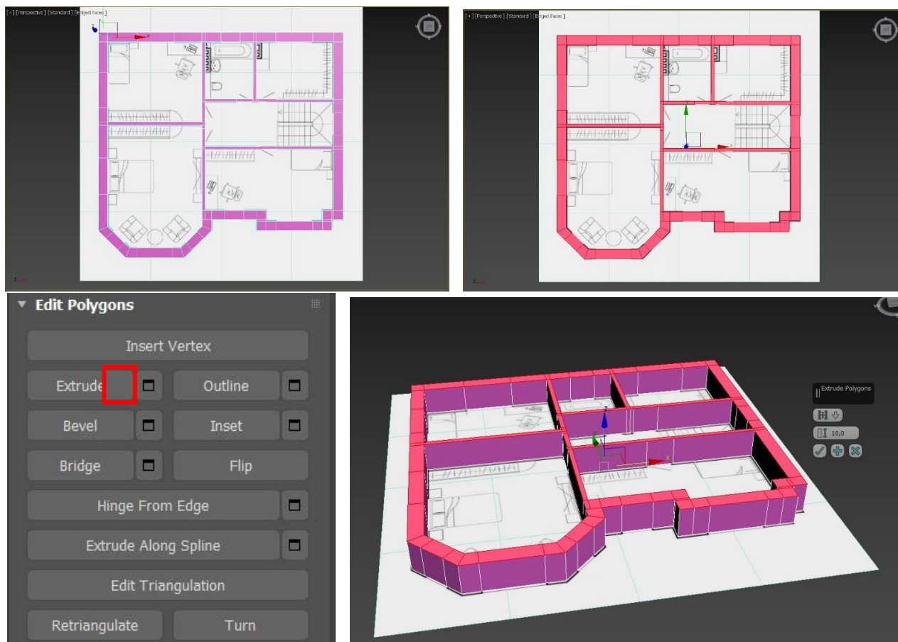
Рисунок 9. Использование инструмента «Extrude» в режиме «Editable Poly»
